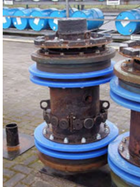
Abbildung 84: Reinigungsmolch mit Plastikmanschette
