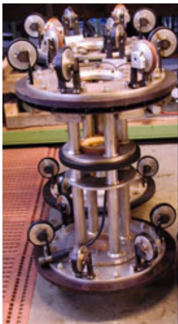
Abbildung 85: Molch zur Rissprüfung
