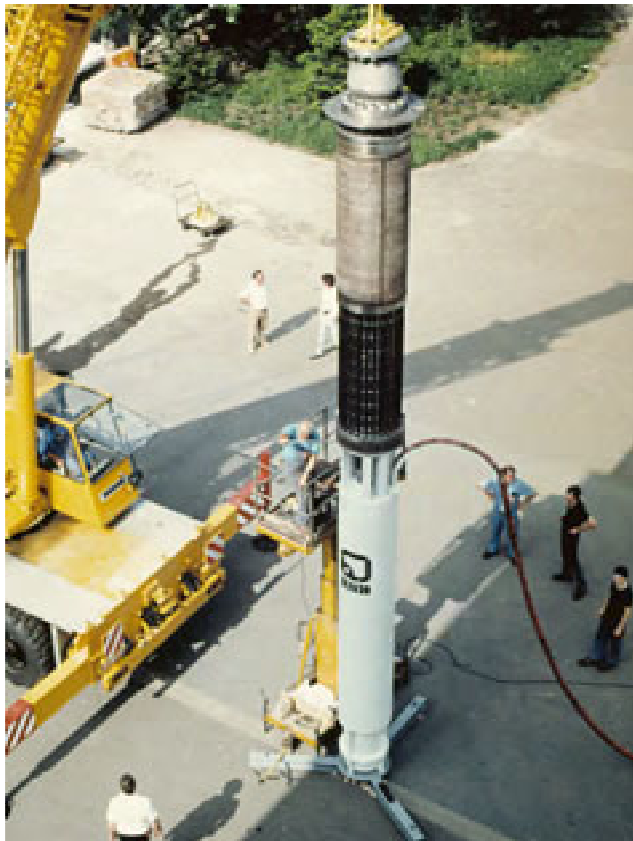
Abbildung 81: Beispiel Nass aufgestellte Rohrpumpe von KSB
