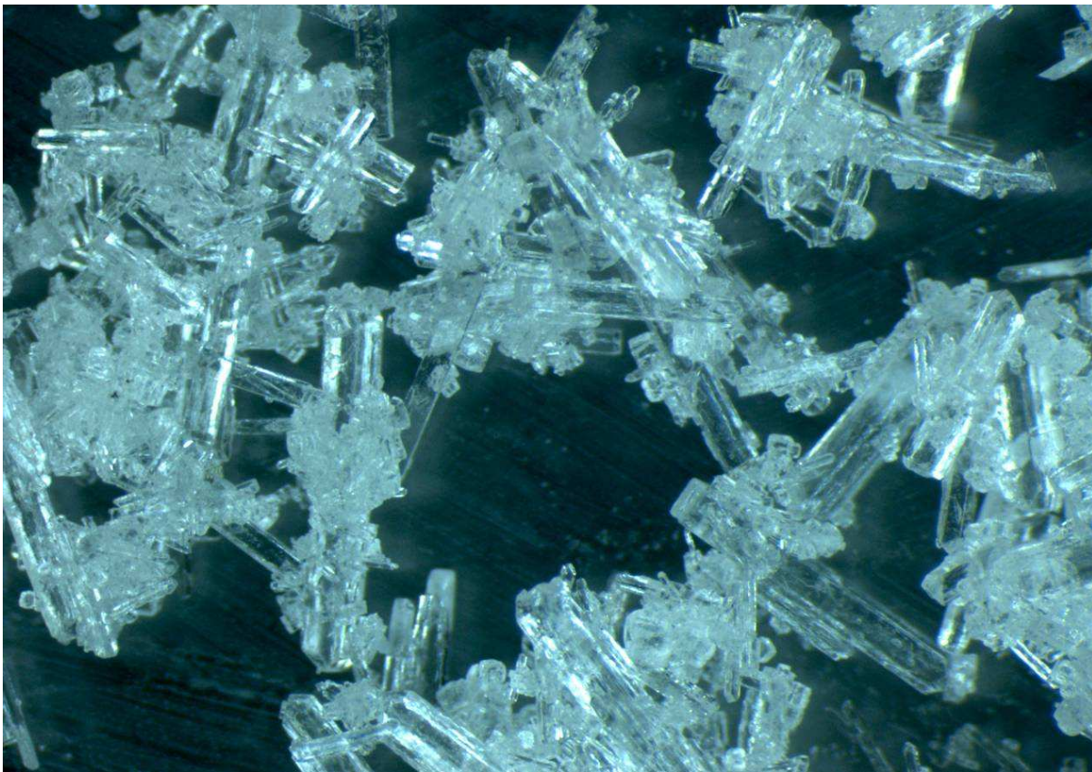
Abb. 6.1: Bittersalz- und Kaliumchloridkristalle aus der Pilotanlage zur Tiefkühlung der Hartsalzabstoßlösung in Hattorf
