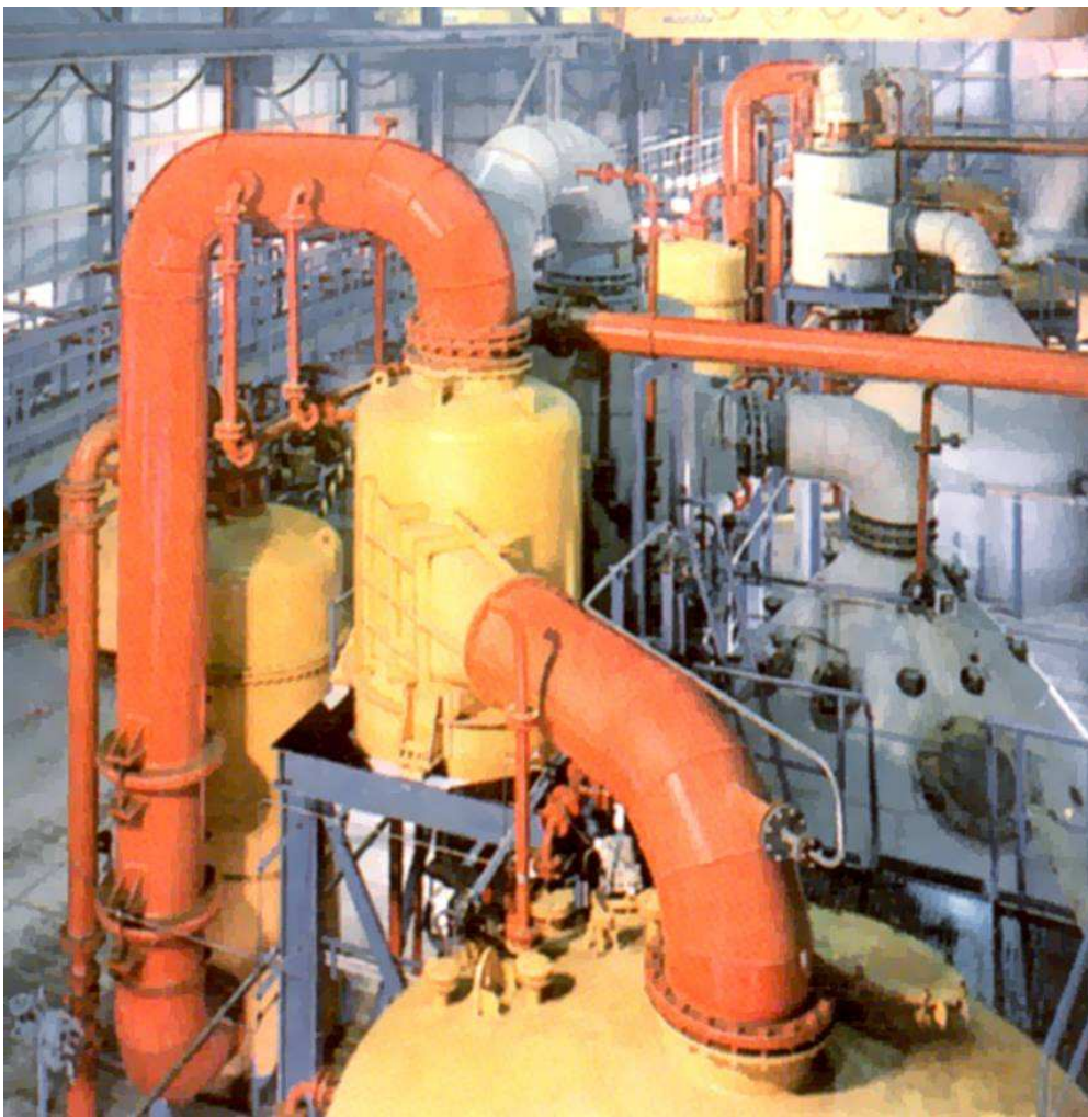
Abb. 6.3: Bild einer Eindampfanlage für Salzlösungen
