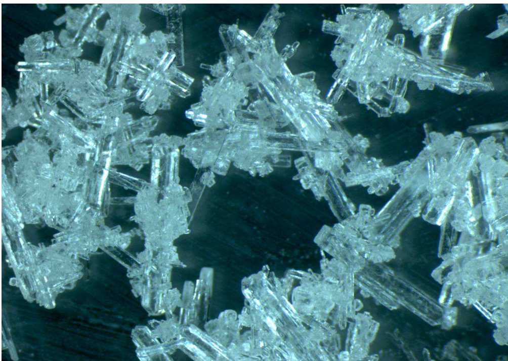
Abb. 6.2: Bittersalz- und Kaliumchloridkristalle aus der Pilotanlage zur Tiefkühlung der Hartsalzabstoßlösung in Hattorf
