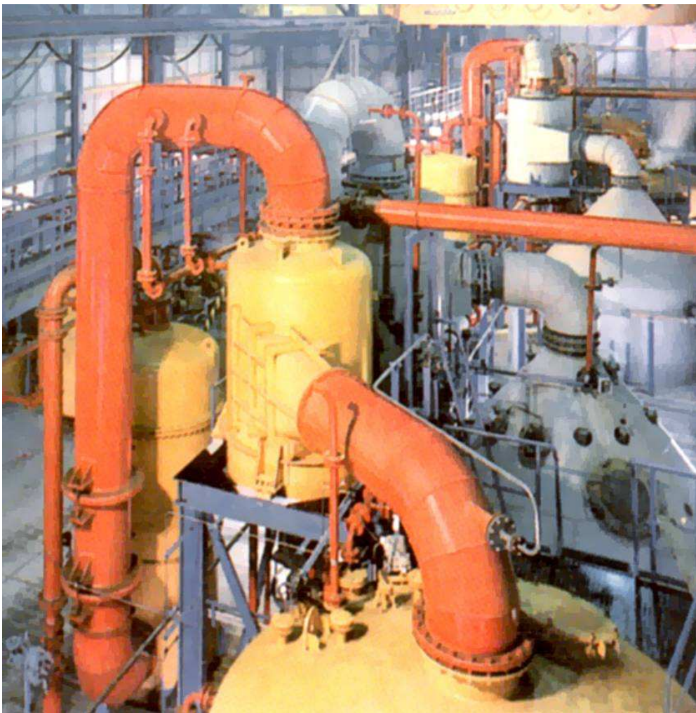
Abb. 6.1: Bild einer Eindampfanlage für Salzlösungen
