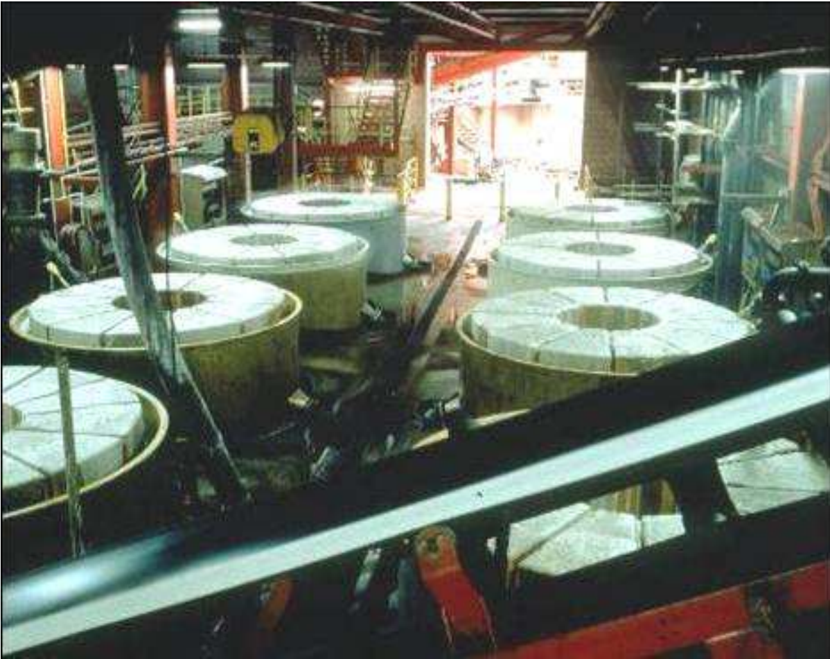
Abb. 6.3: Kieseritflotation des Standorts Hattorf
