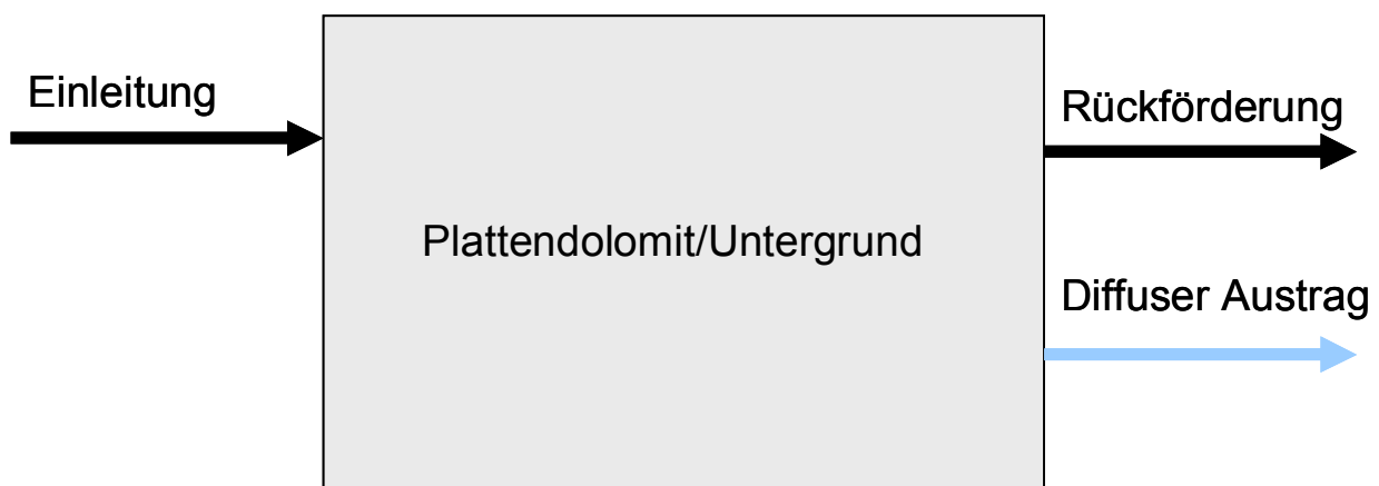
Abb. 4-32: Schema der Salzfrachtbilanz bei der Einleitung von Salzabwasser in den Plattendolomit und einer Rückförderung aus dem Untergrund sowie der diffuse Salzaustrag aus dem Plattendolomit/Untergrund
