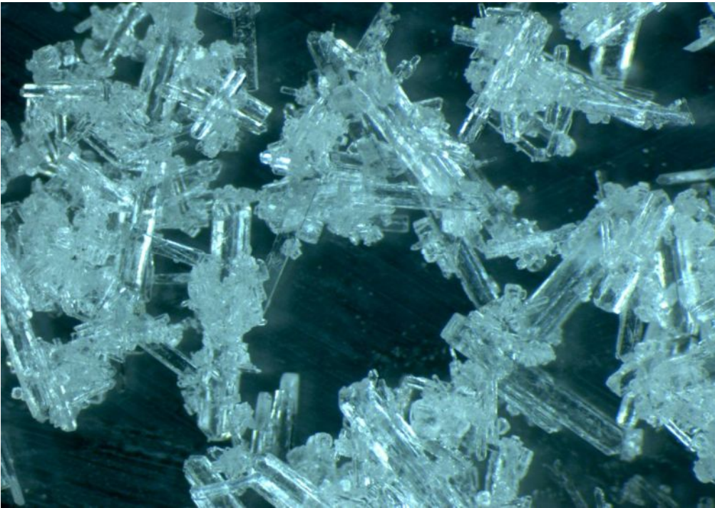
Abb. 4-42: Bittersalz- und Kaliumchloridkristalle aus der Pilotanlage zur Tiefkühlung der Hartsalzabstoßlösung in Hattorf
