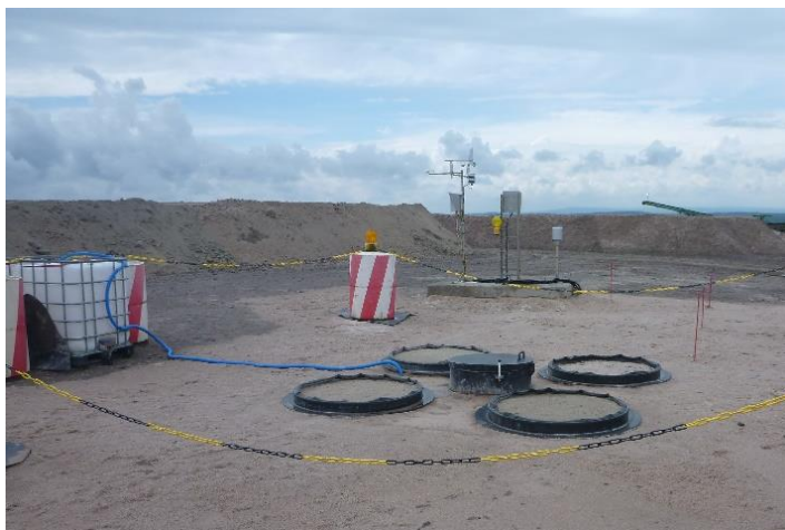
Abb. 6: Lysimeteranlage inkl. Wetterstation auf dem Haldentop der Halde Neuhof-Ellers
