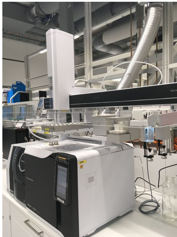
Abbildung 10: GC-MS/MS Gaschromatographie Massenspektrometer Triple Quad (Shimadzu)
