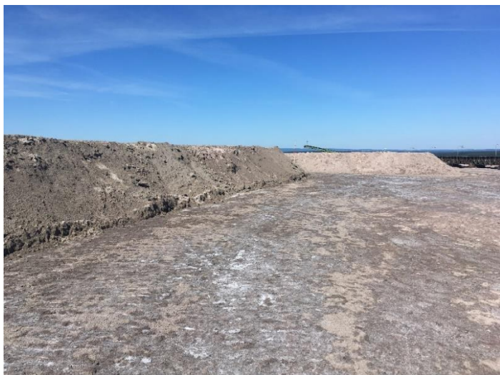
Abb. 5: IES Probefeld (links) und Referenzfeld aus reinem Rückstand auf dem Haldentop der Halde Neuhof-Ellers
