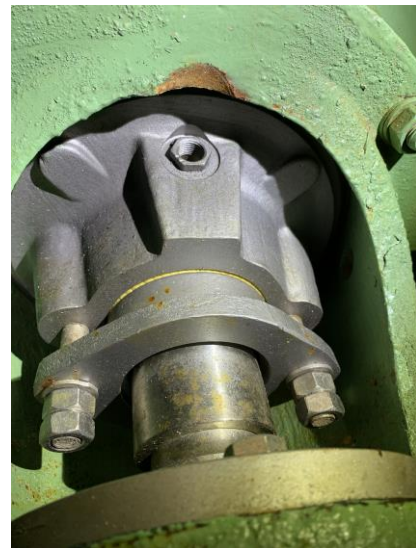
Abbildung 11: links gezopfte Pumpen-Abdichtung, sog. ‚Packung‘, rechts deren Platzierung auf der Pumpenwelle
